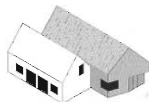
5 Casa raddoppiata / Doubled house extension +107,20 mq / sqm, struttura e rivestimento in legno / timber frame structure with wooden cladding
